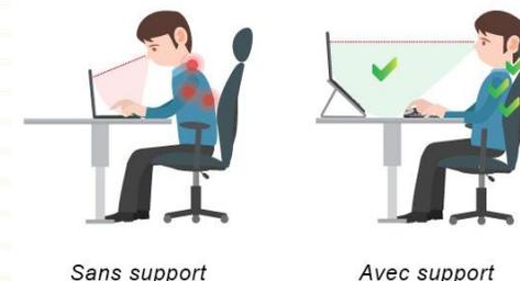
Figure 2 : Installation au poste de travail avec un ordinateur portable, avec et sans support pour l'ordinateur.
